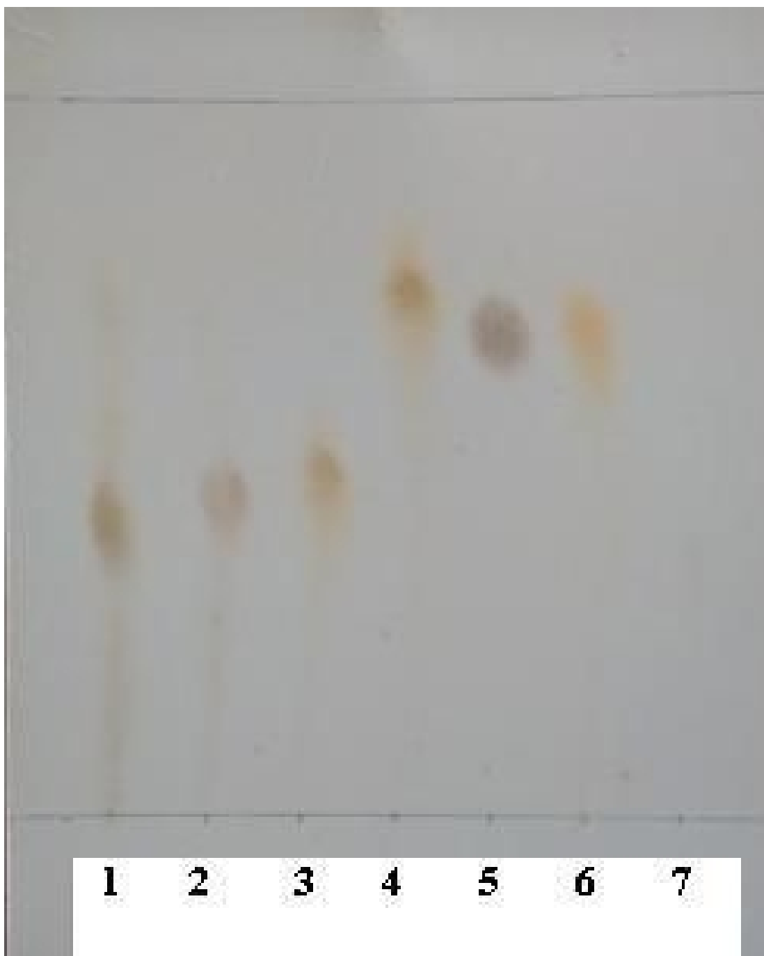
Рис. 2. Тонкослойная хроматограмма веществ и водно-спиртового извлечения из травы одуванчика лекарственного ( n -бутанол – ледяная уксусная кислота – вода, 4 : 1 : 2): детекция веществ проявлением щелочным раствором диазбензолсульфоуксусной кислоты.
