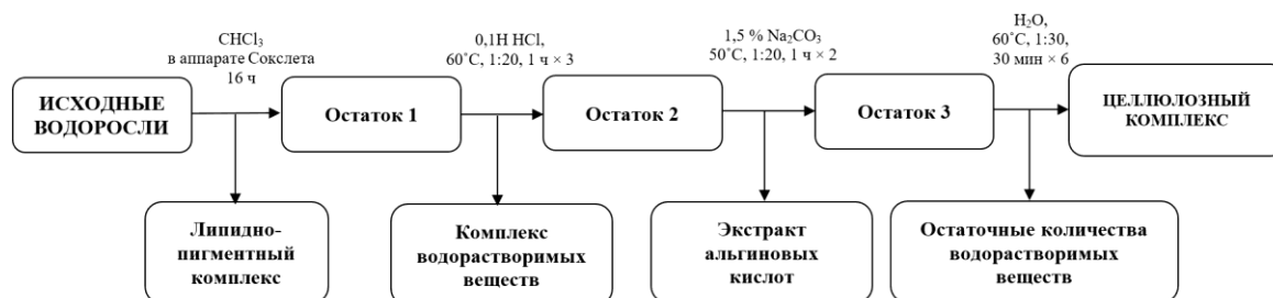
Рис. 1. Схема получения целлюлозного комплекса
