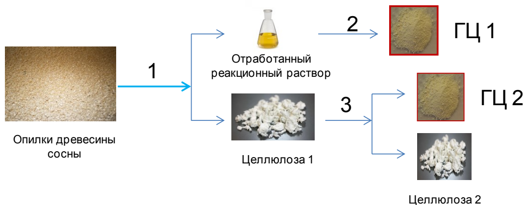
Рис. 1. Схема выделения гемицеллюлоз из опилок древесины сосны: 1 – Делигнификация (CH 3 COOH – 30 мас.%, H 2 O 2 – 6 мас.%, ГМ 15, 90 °С, 3 ч, кат. (NH 4 ) 6 Mo 7 O 24 ), 2 – Концентрирование на роторном испарителе, осаждение C 2 H 5 OH, 3 – Экстракция 5% NaOH при 60 °С, 1ч, осаждение C 2 H 5 OH
