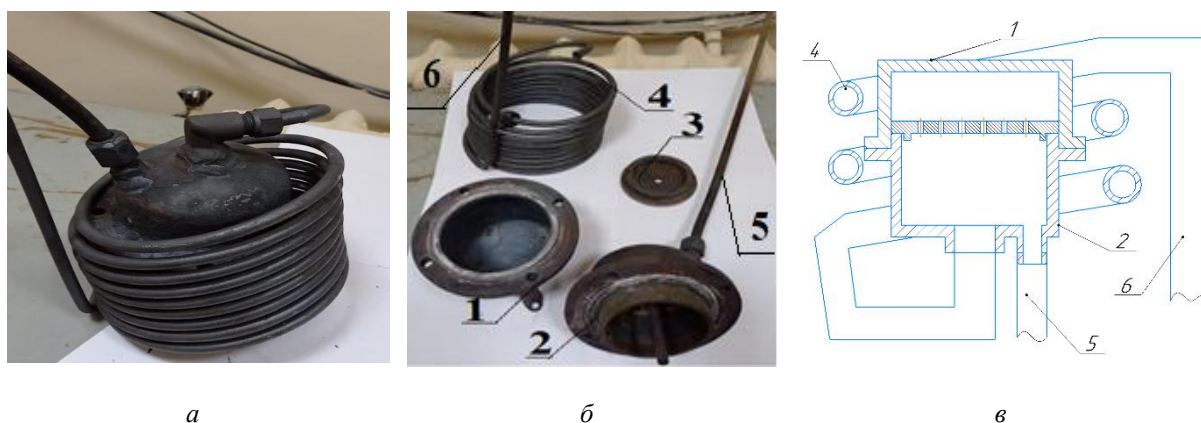
Рис. 2. Внешний вид узла активации: а – в собранном виде; б – разобранном виде. 1 – верхняя часть узла активации, 2 – нижняя часть узла активации, 3 – перфорированная крышка, 4 – змеевик, 5 – патрубки отвода газов активации, 6 – патрубок.
