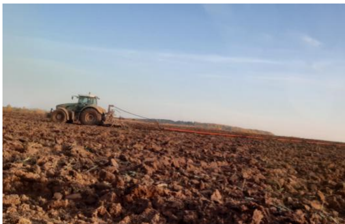
Рис.1. Технология внесения жидкой фракции навозных стоков трактором с буксируемой шланговой системой (фотография авторов)
