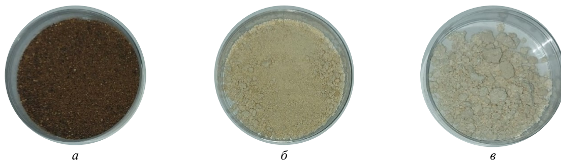
Рис. 4. Образцы ХГК, обработанные при разной концентрации NaOH: а – 1%, б – 3%, в – 12%
