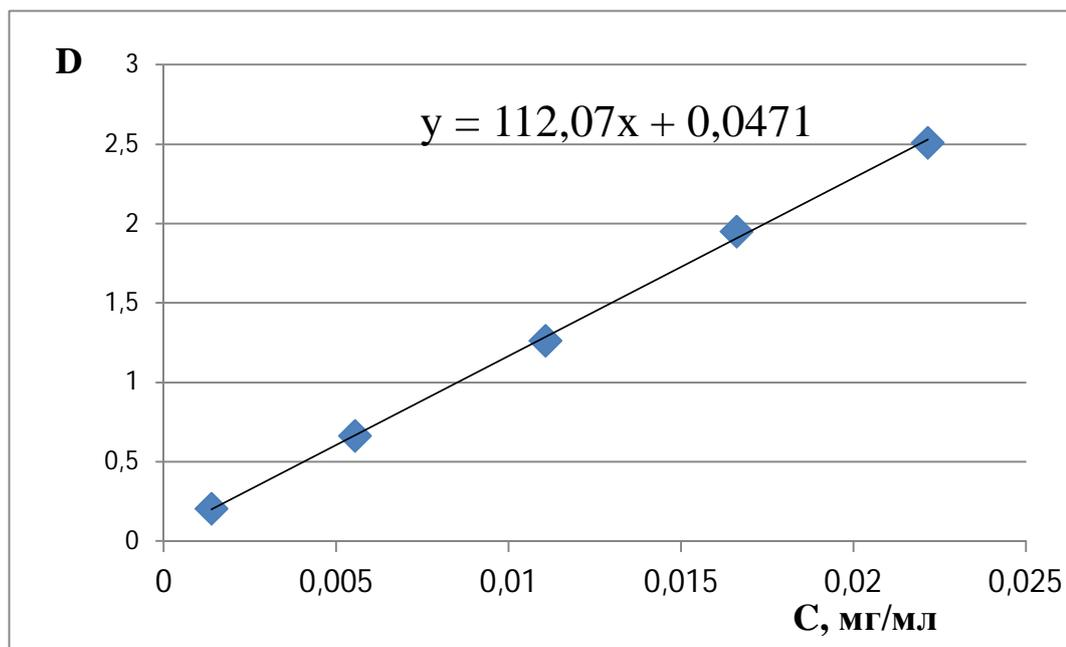
Зависимость оптической плотности растворов (±)-катехина с раствором ванилина в соляной кислоте от концентрации (±)-катехина. Приведено уравнение линейной зависимости «у-х», где х – концентрации (±)-катехина, мг/мл, у – оптическая плотность раствора (±)-катехина при 502 нм
