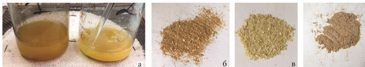
Рис. 2. Оптические изображения суспензий ПЦ после восстановления ионов Ag (а): слева ПЦК+Ag (МС 20), справа ПЦК+Ag (МС 40); композит ПЦК+Ag (МС 20) (б), ПЦК+Ag (МС 40) (в); ПЦ+Ag (ПЦ лиственной целлюлозы) (МС 20) (г)
