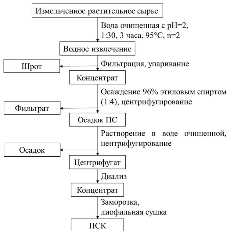
Рис. 1. Схема выделения полисахаридов из травы Saussurea salicifolia L.
