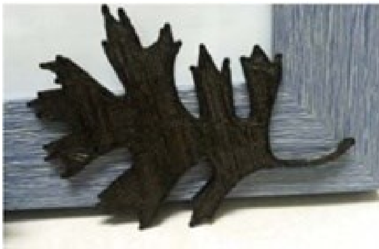
Рис. 2. Изделие, полученное методом 3D-печати из композиции, содержащей 40% органосолVENTного листовенного лигнина, в форме дубового листа [46]
