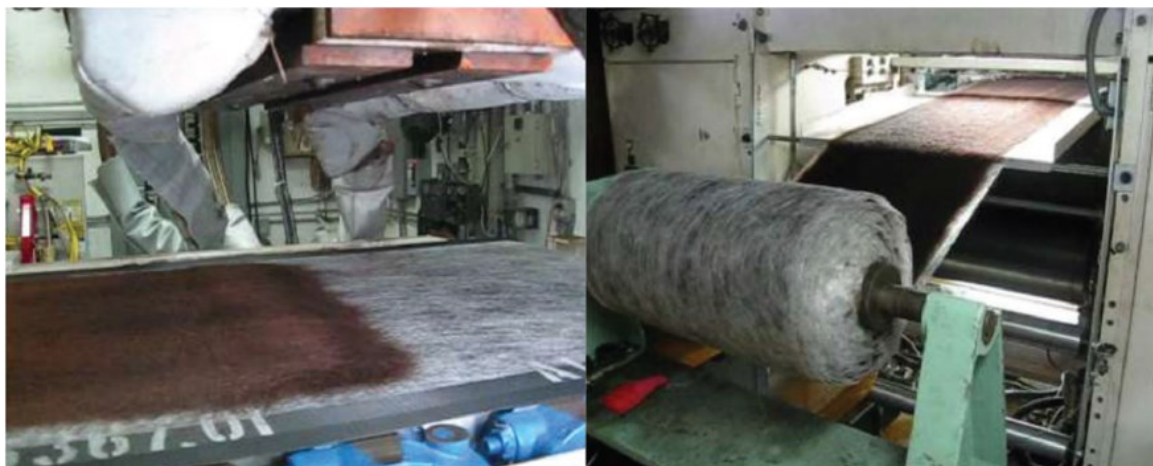
Рис. 3. Лигниновые волокна, сформированные в виде полотна методом прядения из расплава [53]
