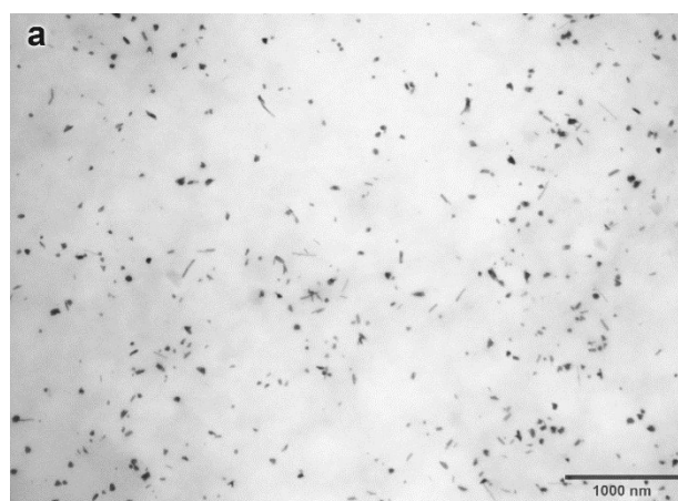
Рис. 2. ПЭМ микрофотография нанобиокомпозита селена ( \nu=0.04 )
