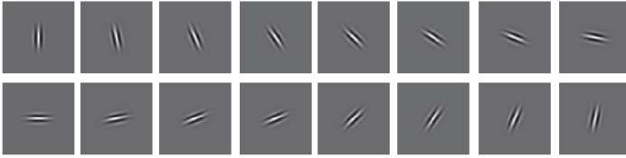
Рисунок 3 – Примеры фильтра Габора с различными ориентациями
