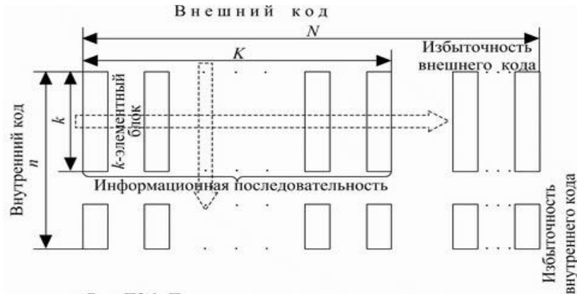
Рисунок 1 – Процедура кодирования каскадным кодом
