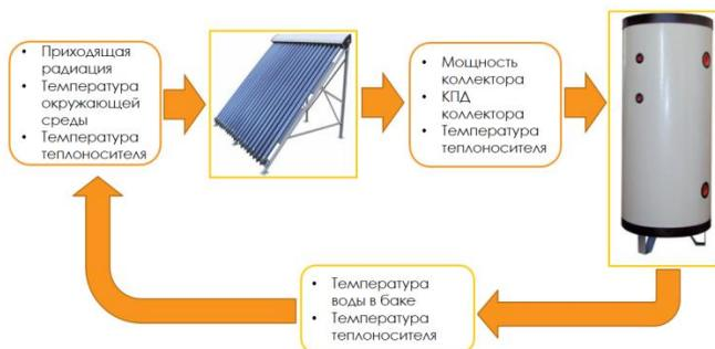
Рисунок 1 – Структурная схема модели солнечного теплоснабжения
