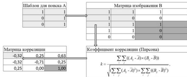
Рисунок 2. Схема построения матрицы корреляции
