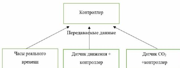
Рис. 1. Схема охранно-пожарной сигнализации.
