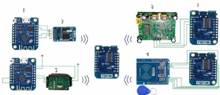
Рис. 2. Вид разработанного устройства. 1 – WeMos D1 Mini, 2 – MH-Z19, 3 – DS3231, 4 – RFID-RC522, 5 – HC-SR501.
