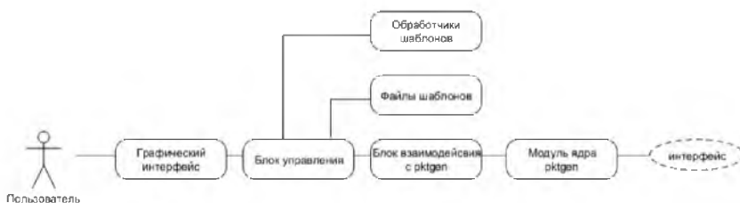
Рис. 1. Структура разработанного программного решения в нотации UML.
