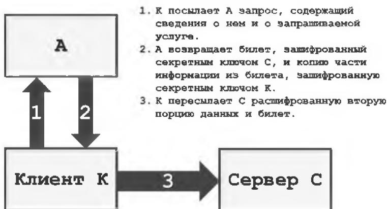
*Рис. 2. Упрощенная схема предложенного метода аутентификации пользователя.*
