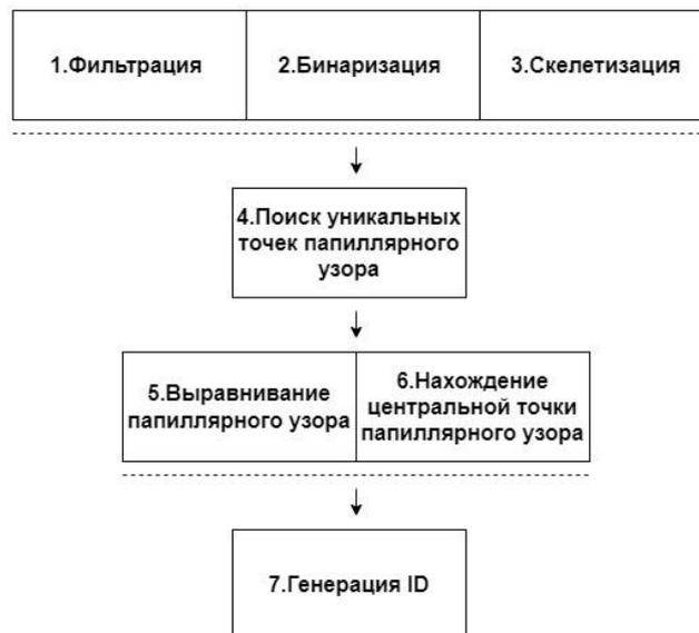
Рисунок 1. Схема разработанного алгоритма
