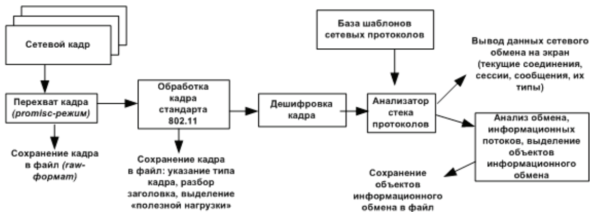
Рис. 1. Схема работы анализатора трафика беспроводной сети
