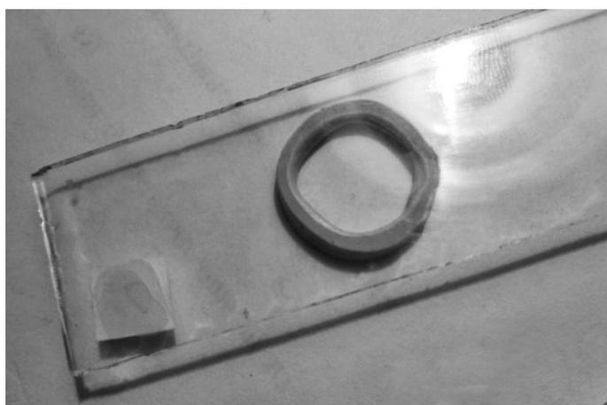
Рис. 1. Камера Ван-Тигема (вид снизу)
