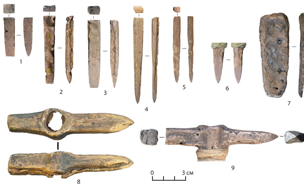
Рис. 2. Экспериментальные изделия: 1–3 – зубила; 4–6 – остроконечные орудия; 7 – долотовидное орудие; 8, 9 – чеканы (1, 6 – медь; 2, 4, 8 – бронза оловянистая 4–5% Sn; 3, 5, 7, 9 – бронза оловянистая 7–8% Sn)
