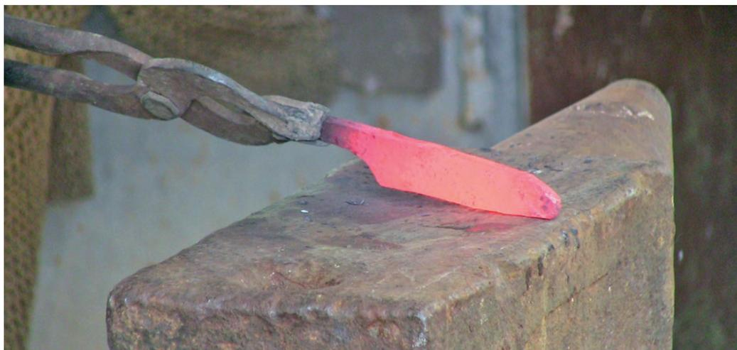
Рис. 5. Ковка ножа
