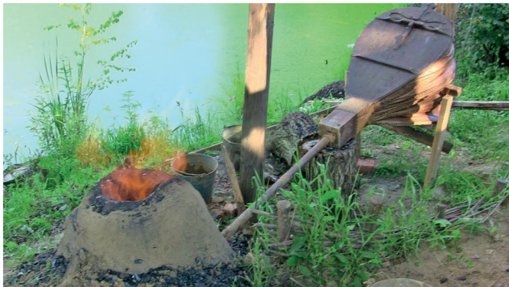
*Рис. 2. Работа экспериментального горна с ручными мехами*
