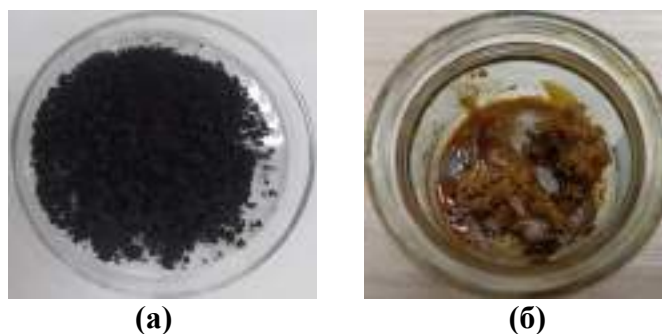
Рис. 3. Фотографии продуктов пиролиза: твердый остаток (а); пиролизная жидкость (б)
