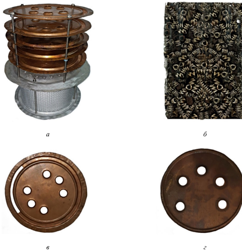
Рис. 1. Общий вид насадочной тарелки перекрестного тока (а), спирально-призматической насадки (б), верхней профилированной пластины (в) и нижней пластины для отвода конденсата (г)
