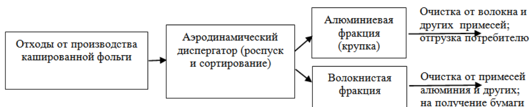
Рис. 2. Схема переработки отходов кашированной фольги сухим способом с использованием аэродинамического диспергатора
