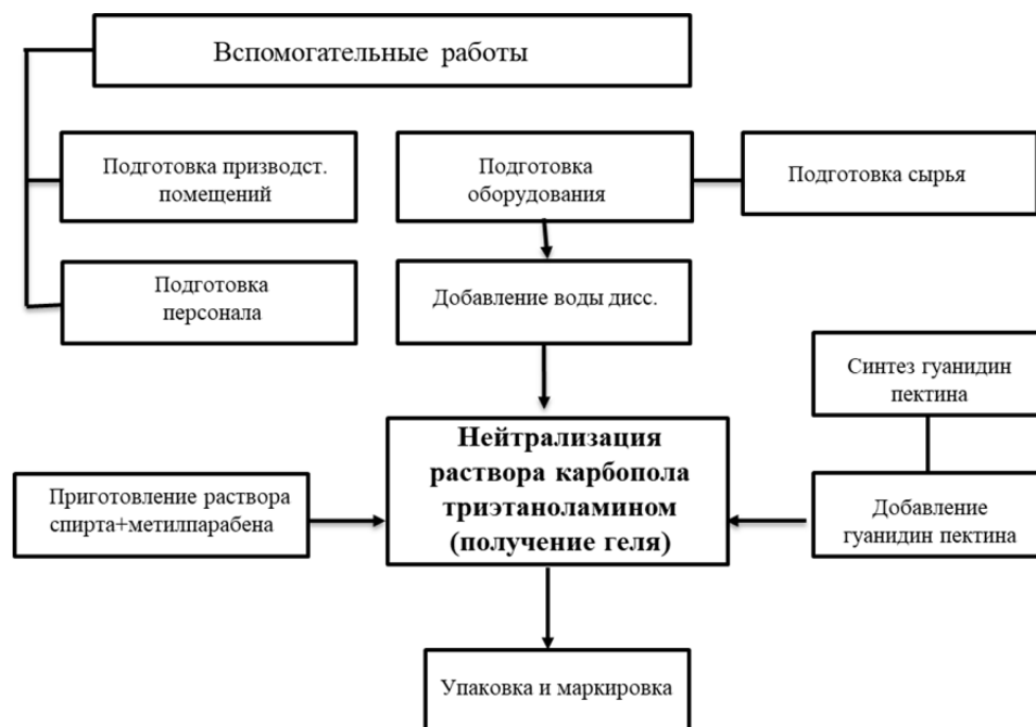
Рис. 7. Блок-схема получения геля гуанидин пектина
