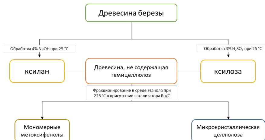
Рис. 3. Схема каталитического фракционирования древесины березы на востребованные химические продукты
