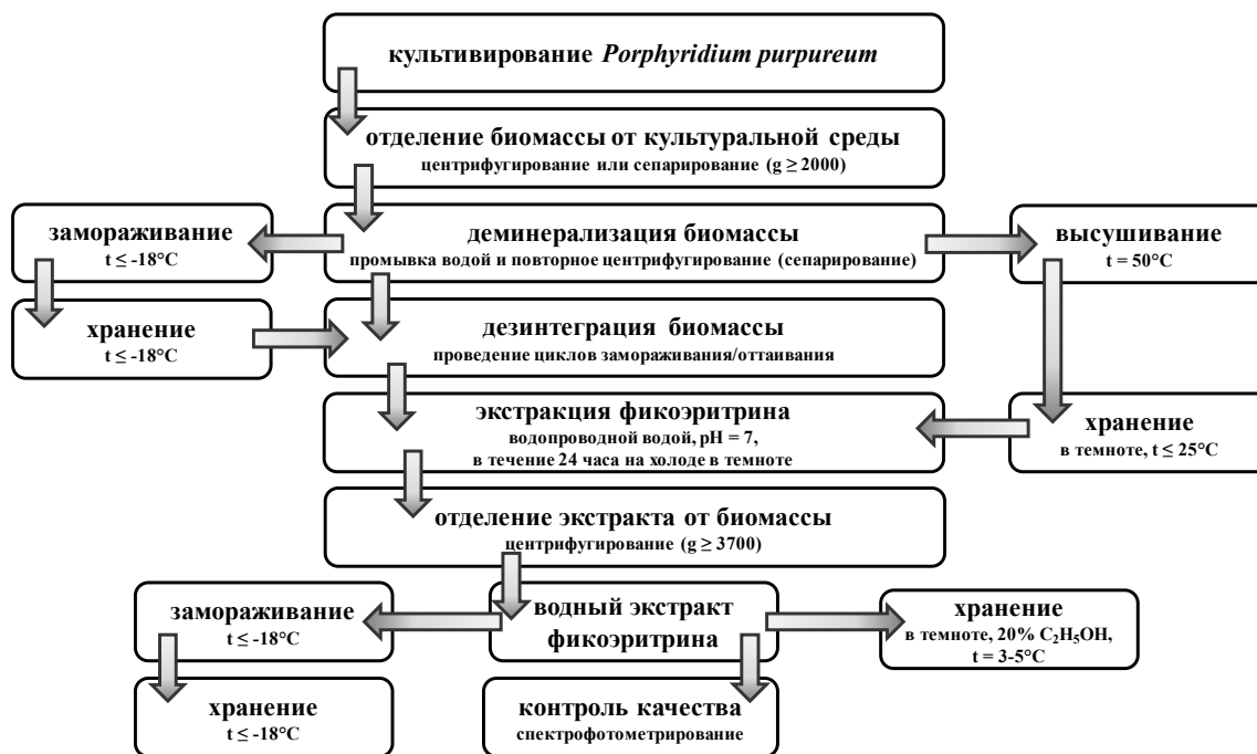
Рис. 1. Технологическая схема получения водного экстракта В-ФЭ из биомассы клеток микроводоросли P. purpureum
