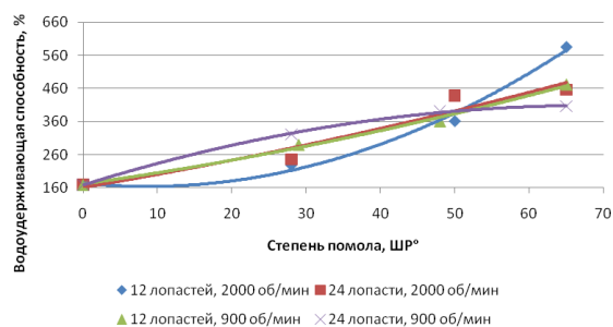
Рис. 3. Водоудерживающая способность от степени помола по шкале Шоппер-Риглера: №1 – 12 лопаток, 2000 об./мин; №2 – 24 лопатки, 2000 об./мин; №3 – 12 лопаток, 900 об./мин; №4 – 24 лопаток, 900 об./мин
