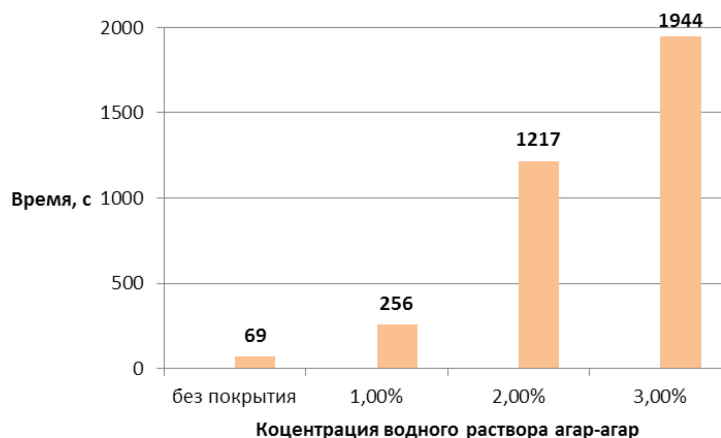
Рис. 4. Влияние концентрации раствора агар-агара на поверхности картона на изменение впитывающей способности капельным методом
