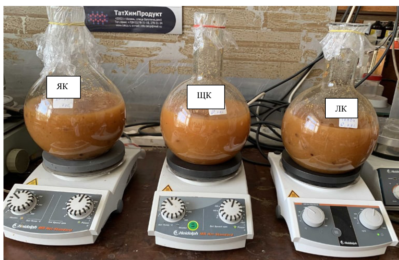
Рис. 2. Процесс гидролиза-экстракции пектина из яблочных выжимок с использованием янтарной (ЯК), лимонной (ЛК) и щавелевой кислоты (ЩК): А – нагревание в сушильном шкафу; Б – на магнитной мешалке
