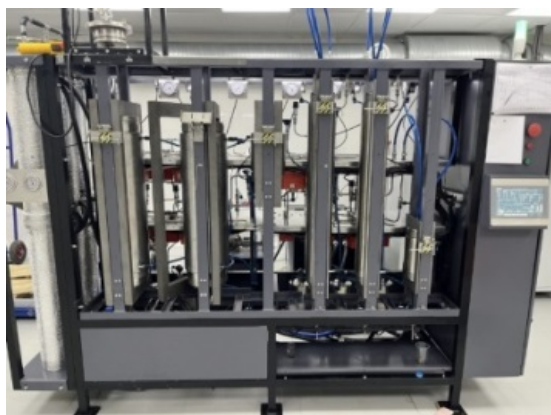
Рис. 2. Установка сверхкритической CO 2 -экстракции «ЭЗТ-10/2-1/1-3-ВА»
