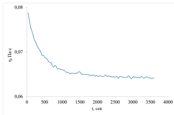
Рис. 6. Изменение динамической вязкости реакционной смеси в процессе синтеза гидрогеля КМЦ4,73ЛК0,71 во времени при постоянной скорости сдвига 400 \text{ с}^{-1} при 50 \text{ °C}
