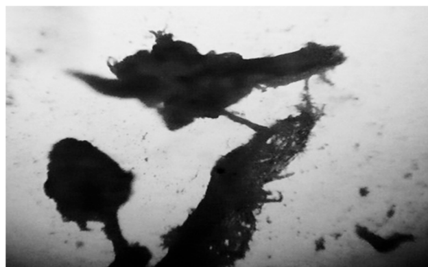
Рис. 3. Микрофотография (×400) частиц порошка ХГК Aspergillus niger после выдерживания в 5% растворе гидроксида натрия в течение 1 ч
