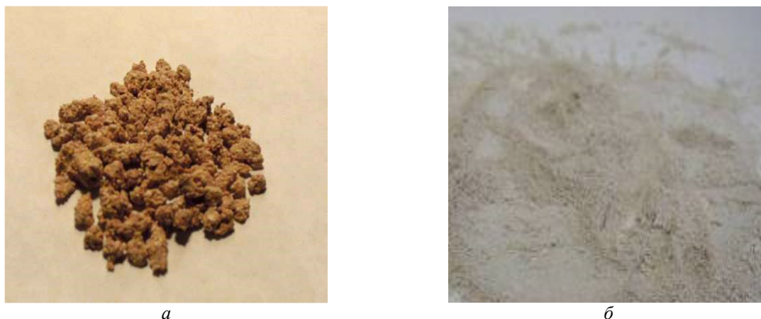
Рис. 1. ХГК Aspergillus niger – отход производства лимонной кислоты: а – в гранулах; б – в виде порошка
