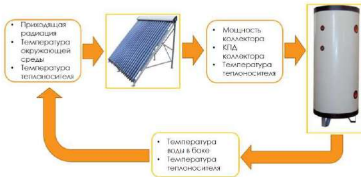
Рисунок 1 – Структурная схема модели солнечного теплоснабжения
