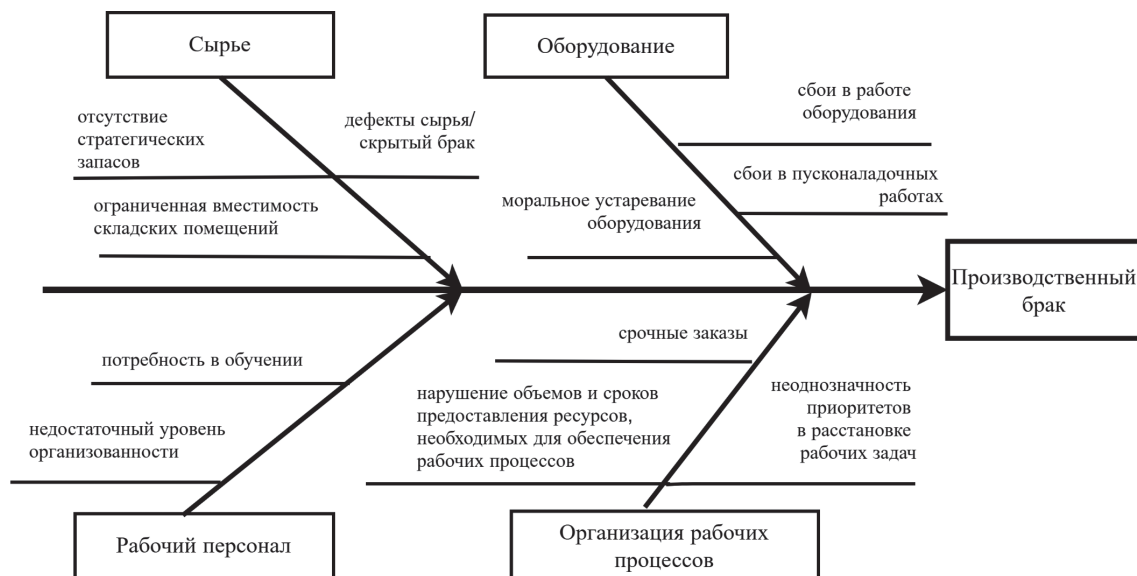
Рисунок 3 — Диаграмма Исикавы «Выявление производственного брака в процессах упаковки товара» Figure 3 — Ishikawa diagram «Identification of manufacturing defects in product packaging processes»
