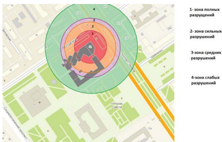
Зонирование территории по степени повреждения корпусов «М (+Л)» АлтГУ
